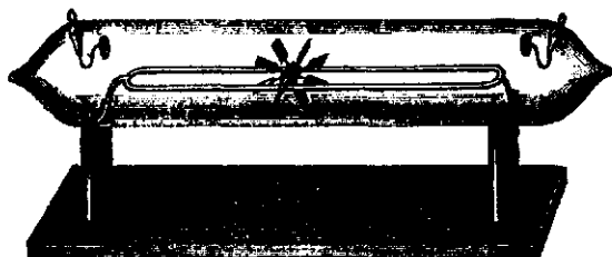
ТРУБКИ КРУКСА: КАТОДНЫЕ ЛУЧИ ЗАСТАВЛЯЮТ СВЕТИТЬСЯ БРИЛЛИАНТ, ОСТАВЛЯЮТ ТЕНЬ ОТ МАЛЬТИЙСКОГО КРЕСТА И ДВИГАЮТ ЛОПАТКИ КРЫЛЬЧАТКИ, ОКАЗАВШЕЙСЯ НА ИХ ПУТИ
